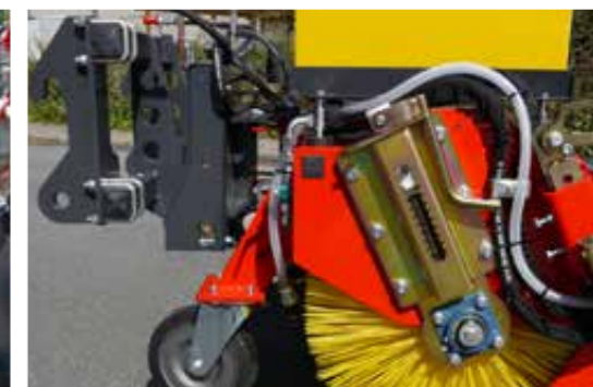
Shovel of verreiker opname met 3D niveauregeling en rollengeleiding
