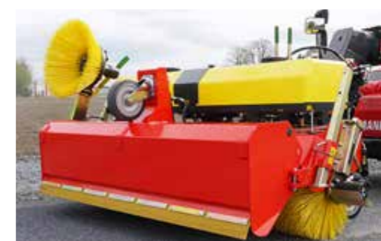
Vegen onder de bak door. Opvangbak hydraulisch kiepend met 3e steunwiel
